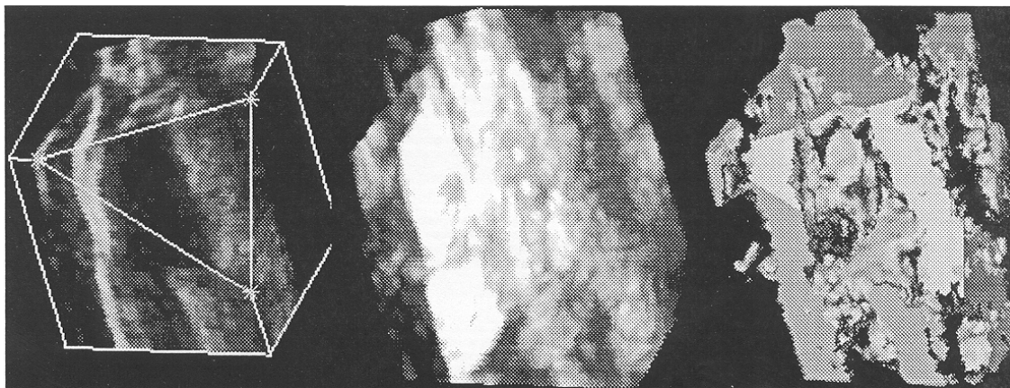
Figur 2. Viser (a) volumdeling, (b) maksimum-intensitets strålefølging og (c) skyggelagt strålefølging.
